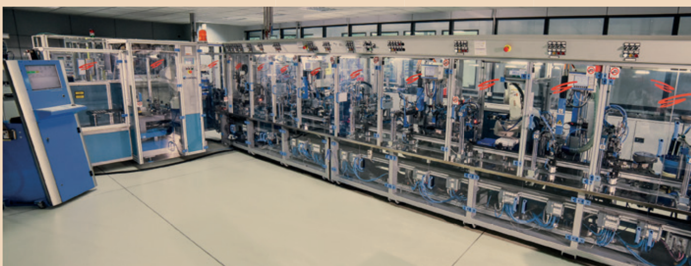
UN IMPIANTO REALIZZATO DA COSBERG PER IL MONTAGGIO E IL COLLAUDO DI VALVOLE ELETTROPILOTA
